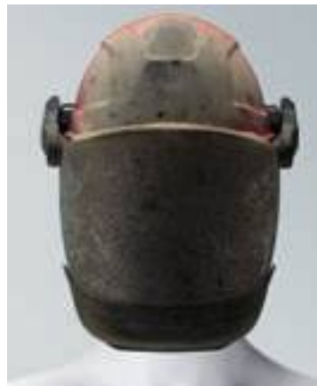
Après un arc électrique de 7 kA
